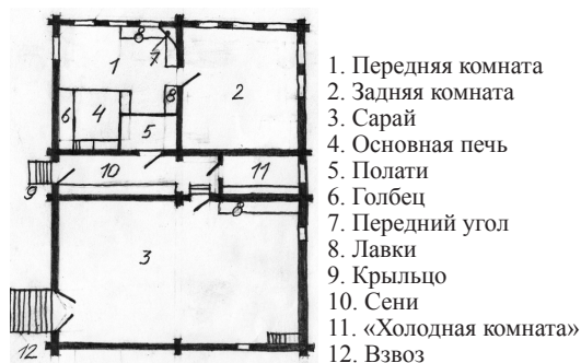
Рис. 3. Внутренняя планировка сысольской избы. Технический эскиз по материалам экспедиции по Сысольскому району. Разработка автора. 2012 г.
